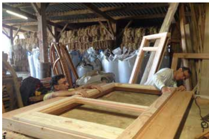
Fabrication des portes
