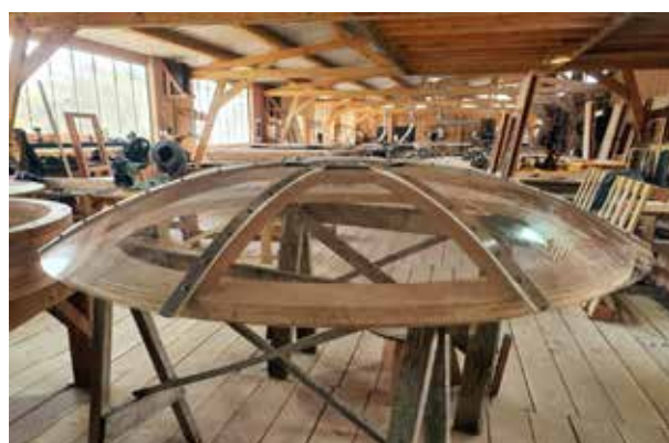
toono ouvrant en Altuglas 2mm
