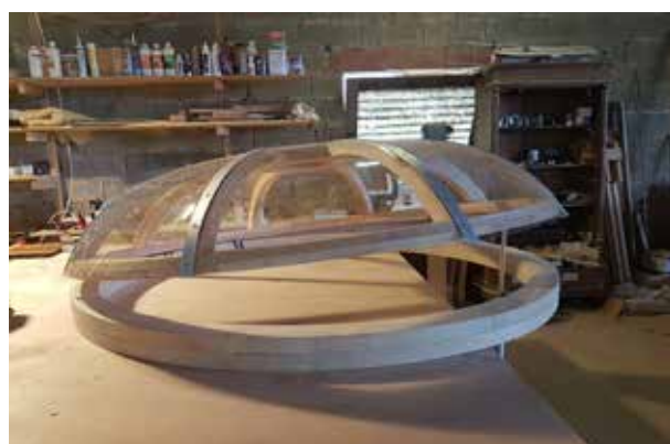
toono ouvrant en Altuglass 2mm
