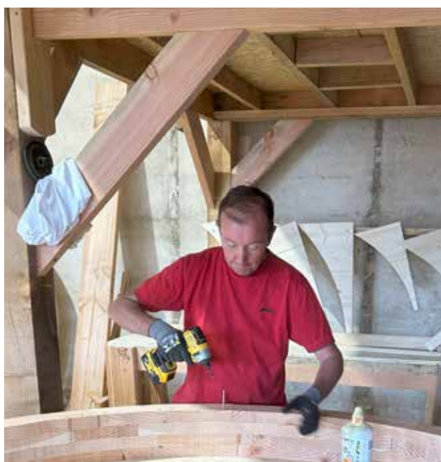
Fabrication d'un toono (couronne)
