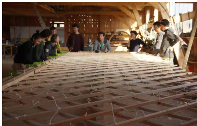
Fabrication d'un treillis en autoconstruction
