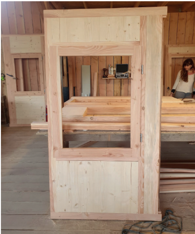
Fenêtre verticale ouverture intérieure
