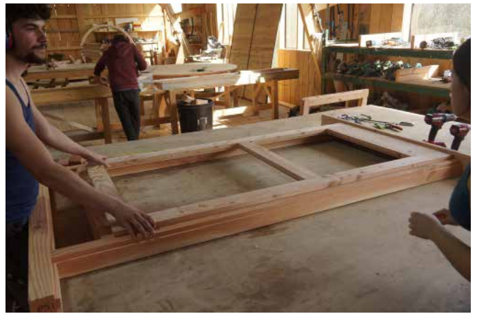
Fabrication des portes en autoconstruction
